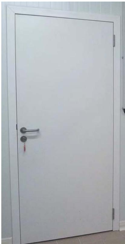
Portes semi-isolées pour locaux en température positive. Simple ou double battant, en mousse de polyuréthane injecté haute densité (45 Kg/m<sup>3</sup>) entre deux parements de tôle d'acier galvanisé laqué épaisseur 60/100°, revêtue d'un film protecteur pelable.
