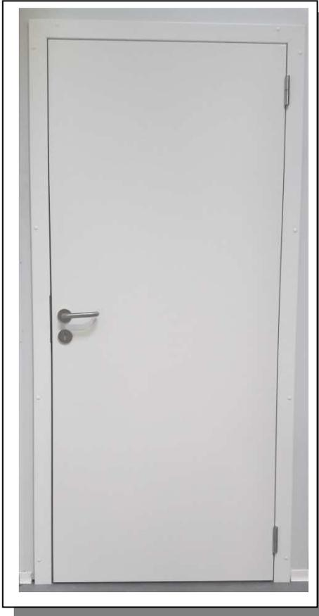
Portes semi-isolées pour locaux en température positive. Simple ou double battant, en mousse de polyuréthane injecté haute densité (45 Kg/m<sup>3</sup>) entre deux parements en tôle d'acier galvanisé laqué épaisseur mini 60/100°, revêtue d'un film protecteur pelable.
