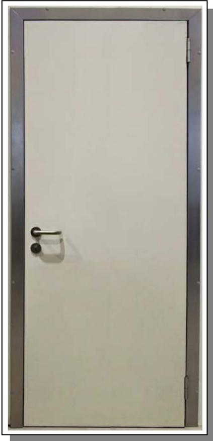
Portes semi-isolées pour locaux en température positive. Simple ou double battant, en mousse de polyuréthane injecté haute densité (45 Kg/m<sup>3</sup>) entre deux parements en tôle d'acier galvanisé laqué épaisseur mini 60/100°, revêtue d'un film protecteur pelable.
